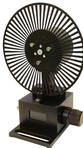
OCV-6300F оптический модулятор с диском 60 отверстий
