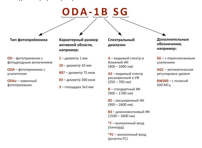
**Пример:** ODA-08AF — Фотоприемник с усилителем, диаметр активной области 800 мкм, видимый спектр и ближний ИК (400 - 1000 нм) с волоконным входом (пачкорд).
