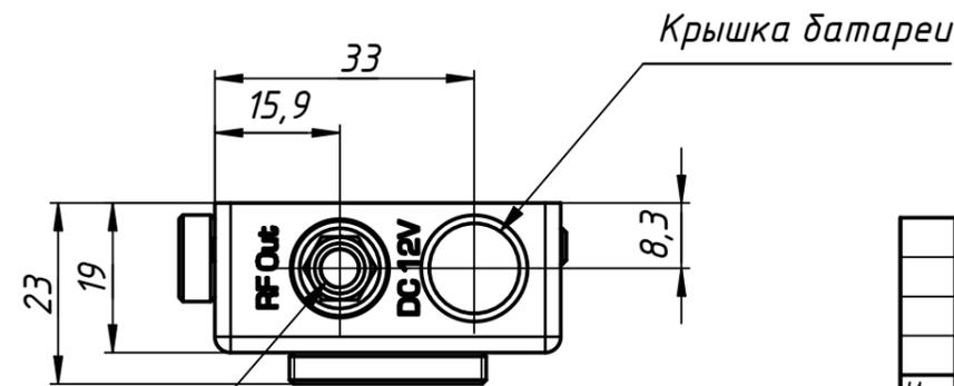
Радиочастотный выход SMA
