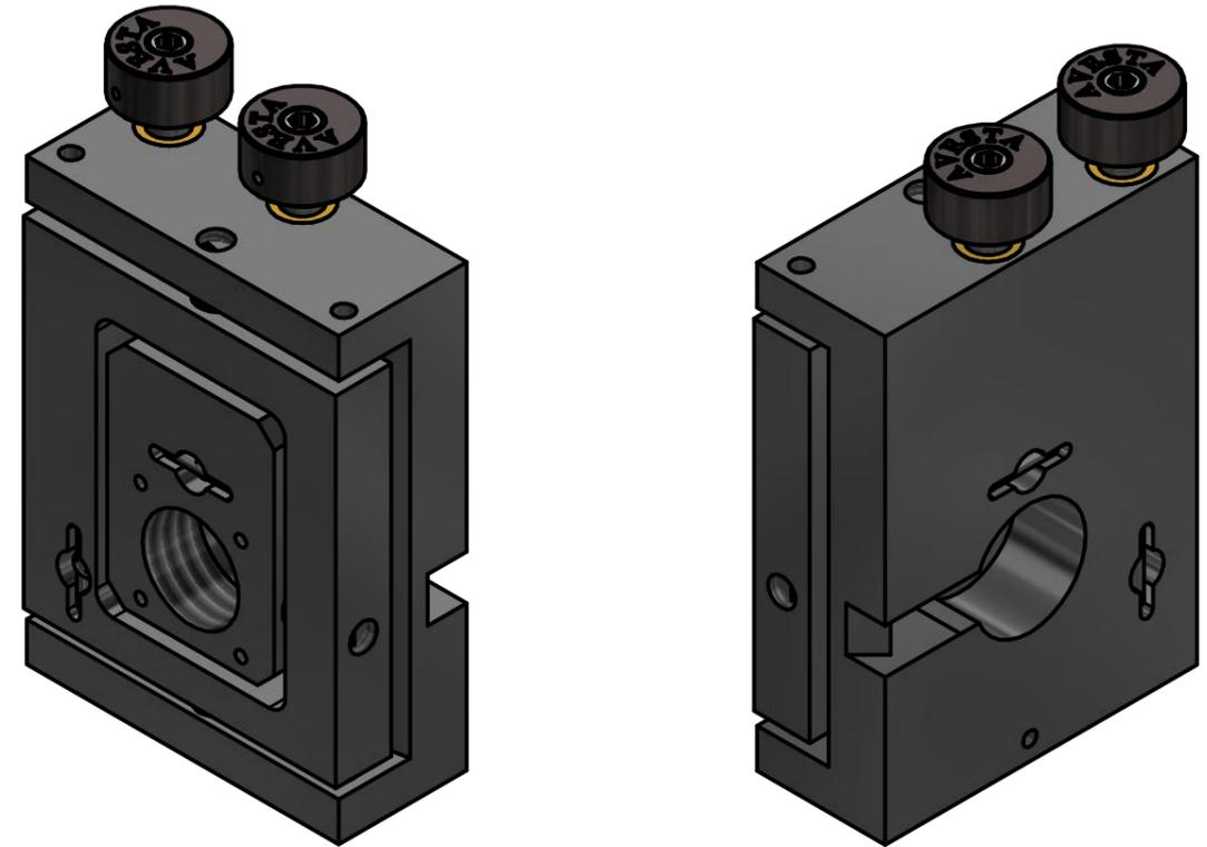
Шарнирный держатель оптики MMG-TH предназначен для установки в компактных оптических системах. Держатель осуществляет наилучшее угловое позиционирование путем применения шарнирной конструкции, которая фиксирует оптическую ось зеркала непосредственно на оси вращения. Конструкция обеспечивает точное вращательное перемещение без угловых погрешностей.
