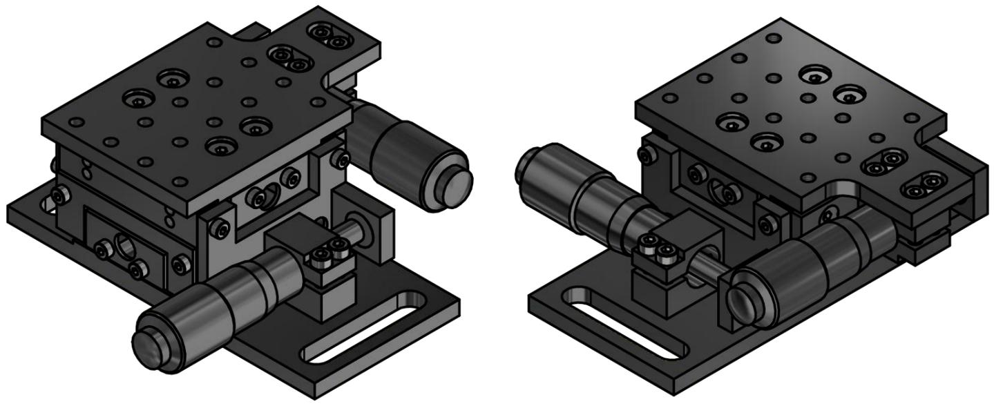
Низкопрофильный двухкоординатный линейный транслятор 2TS3 используется в оптических приборах с ограниченным внутренним пространством и обеспечивает перемещение по двум ортогональным осям.
