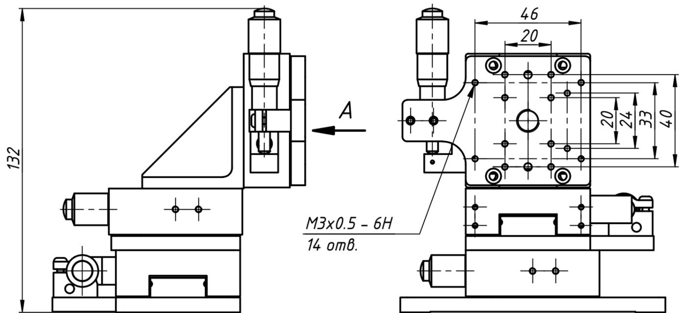
Прецизионный трехкоординатный линейный транслятор ЗТС15-КР15 является комбинацией трех трансляторов TS15-КР15, два из которых соединены посредством специального кронштейна. Платформа обеспечивает плавное перемещение по трем координатным ортогональным осям. ЗТС15-КР15 оснащен тремя высокоточными микрометрическими головками. Транслятор монтируется на пластине основания ВР-6 и устанавливается на оптической плите винтами М6. Корпус изделия выполнен из дюрала и подвергнут химическому чернению.
