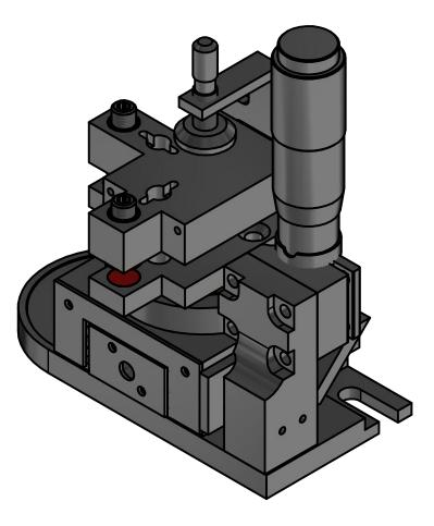
Многоцелевой комбинированный оптический столик MSP-K90 предназначен для крепежа и настройки призмы, кристалла и т.д. Конструкция столика обеспечивает поперечное смещение, поворот вокруг вертикальной оси, наклон в двух плоскостях вблизи горизонтального положения.
