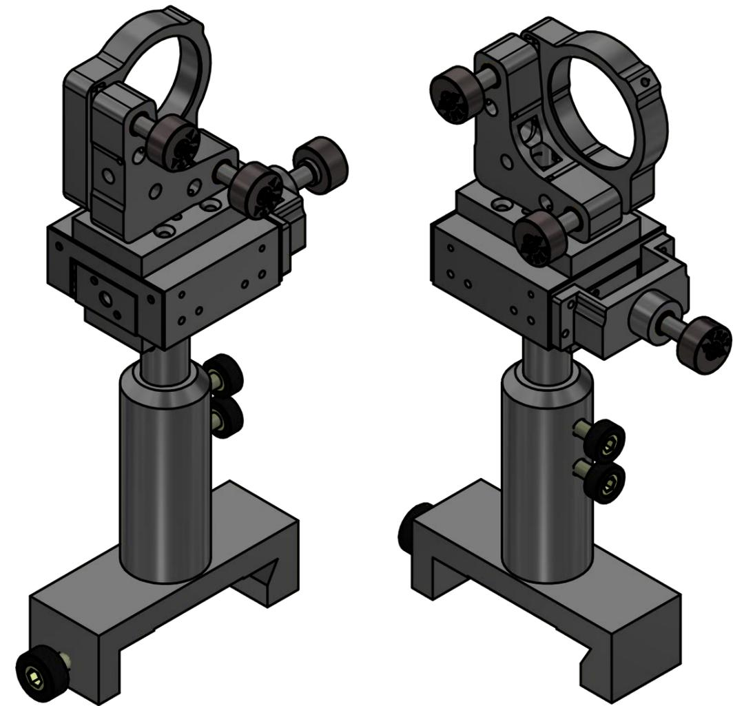
Представленный сборный оптический узел состоит из юстировочной оптической оправы МММ-В40, установленной через плату РС МММ/ТSM на стандартном линейном трансляторе ТSM-В.
