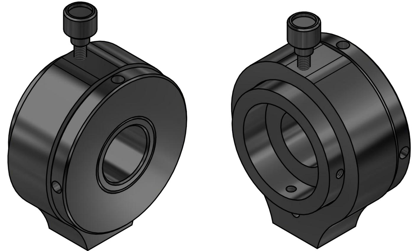
Вращающаяся платформа используется для ручного вращения оптических элементов непрерывно на 360 градусов и фиксации положения винтом М3 сверху. В центре находится отверстие диаметром 15 мм для крепежа оптики. К оптической плите платформа крепится с помощью установочных модулей МРН и отверстия М6 снизу платформы.
