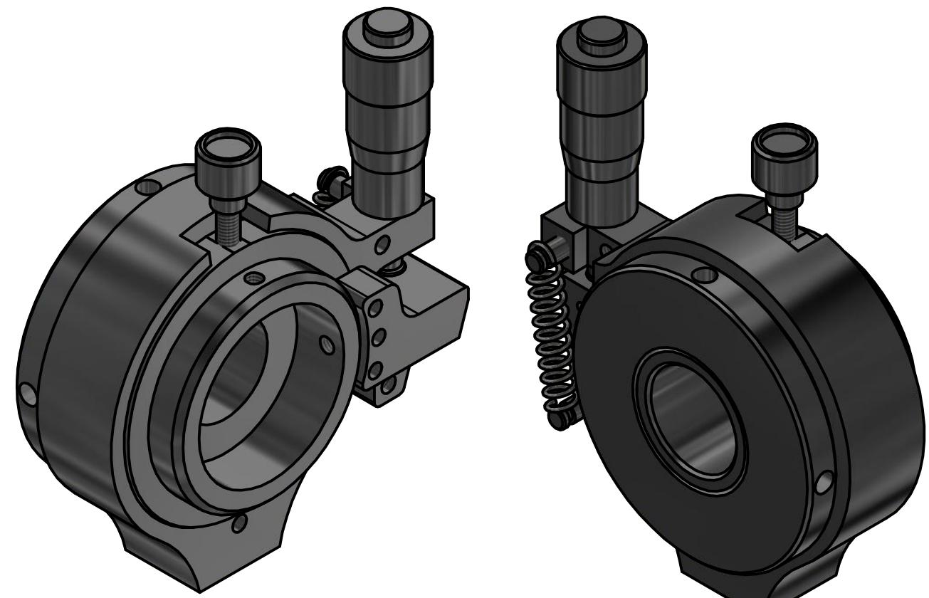
*Вращающая платформа используется для вращения оптических элементов непрерывно на +/- 7 градусов с помощью микрометрического винта. В центре находится отверстие диаметром 15 мм. Для крепежа оптики предусмотрено отверстие диаметром 25 мм с фиксацией сбоку. К оптической платформе крепится с помощью установочных модулей МРН и отверстия М6 снизу платформы. Все детали изготовлены из дюраля и подвергнуты химическому чернению.*
