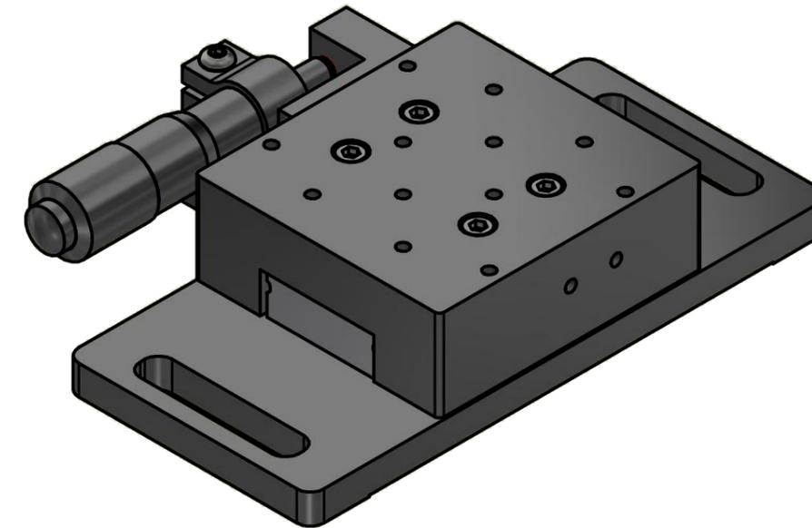
Прецизионный оптический столик многоцелевого назначения TS15-KP15 обеспечивает плавное перемещение. Вариант TS15-KP15 состоит из трех элементов: столика TS16, пластины основания ВР-6, микрометрической головки 15 мм, расположенной параллельно плоскости основания.
