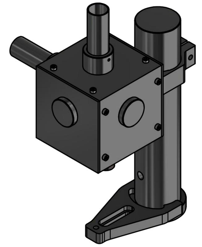
Система поворота луча PR-90 предназначена для изменения хода оптического луча на 90 градусов в оптических системах. Поворотное зеркало установлено в пылезащитном и светозащитном корпусе. Прецизионные юстировочные винты FAS-B25 выведены наружу. Детали PR-90 изготовлены из дюрала и подвергнуты химическому чернению.
