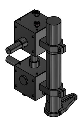
Универсальный перископ PVH-DP служит для изменения высоты оптического луча, его направления и поворота плоскости поляризации.
