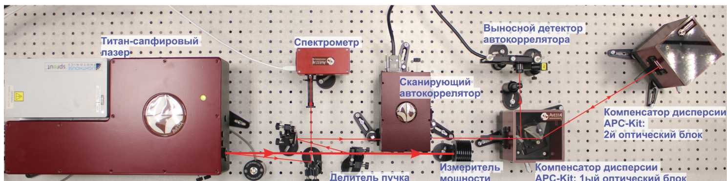
Контроллер дисперсии APC Kit в установке с лазером TiF-15F (15-30 фс), автокоррелятором для микроскопии AA-M, спектрометром ASP-75
