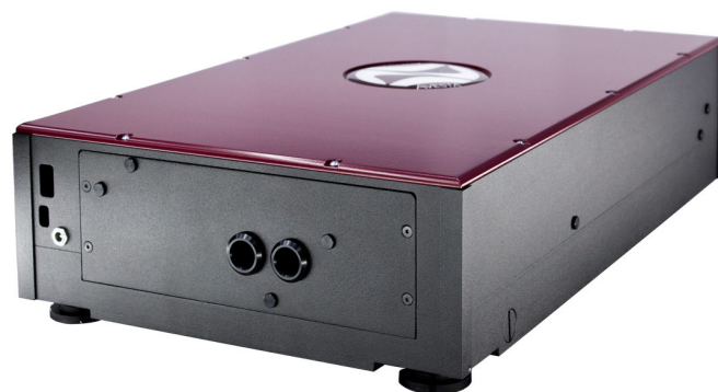
Параметрический фемтосекундный генератор TOPOL-1050-D
