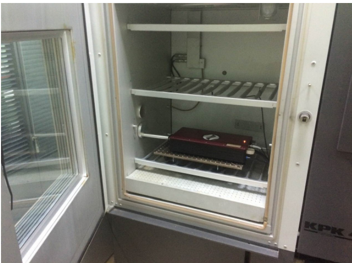
Испытания лазерной системы ТЕМА на долговременную стабильность в условиях переменной температуры окружающей среды (обозначена красным).
