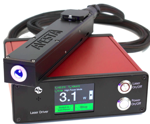
Многомодовый диодный лазер DLM-MM-460n
