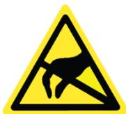
**Внимание!!! Компоненты внутри фотоприёмника чувствительны к электростатическому разряду! При эксплуатации фотоприёмника необходимо обеспечить меры по защите от статического электричества (заземление металлических частей оборудования, использование персоналом антистатических браслетов и т.п.)**
