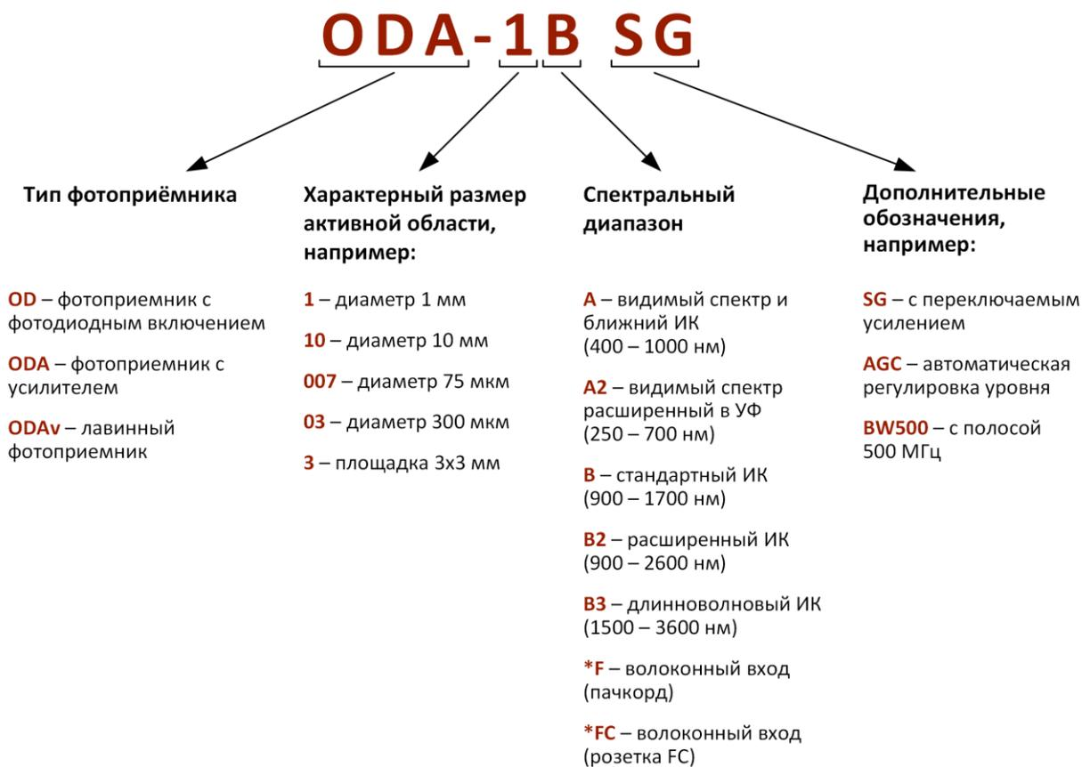
**Пример: ODA-08AF** – Фотоприемник с усилителем, диаметр активной области 800 мкм, видимый спектр и ближний ИК (400 - 1000 нм) с волоконным входом (пачкорд).
