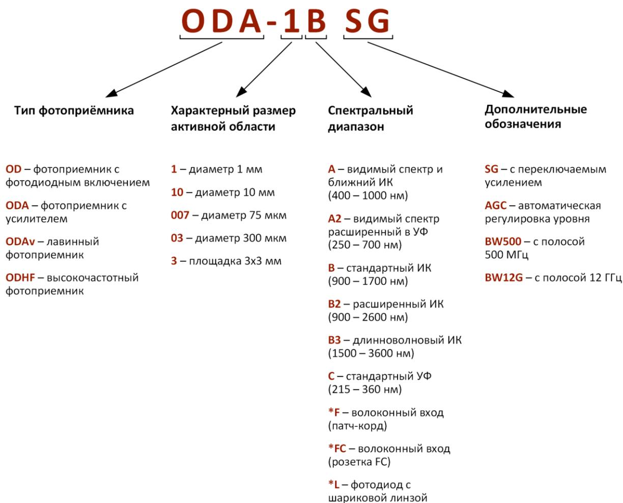
**Пример: ODA-08AF** – Фотоприемник с усилителем, диаметр активной области 800 мкм, видимый спектр и ближний ИК (400 - 1000 нм) с волоконным входом (патч-корд).
