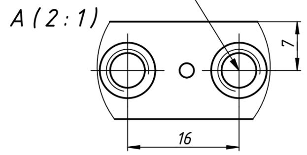
M6x1 фиксирующий винт для оптики
