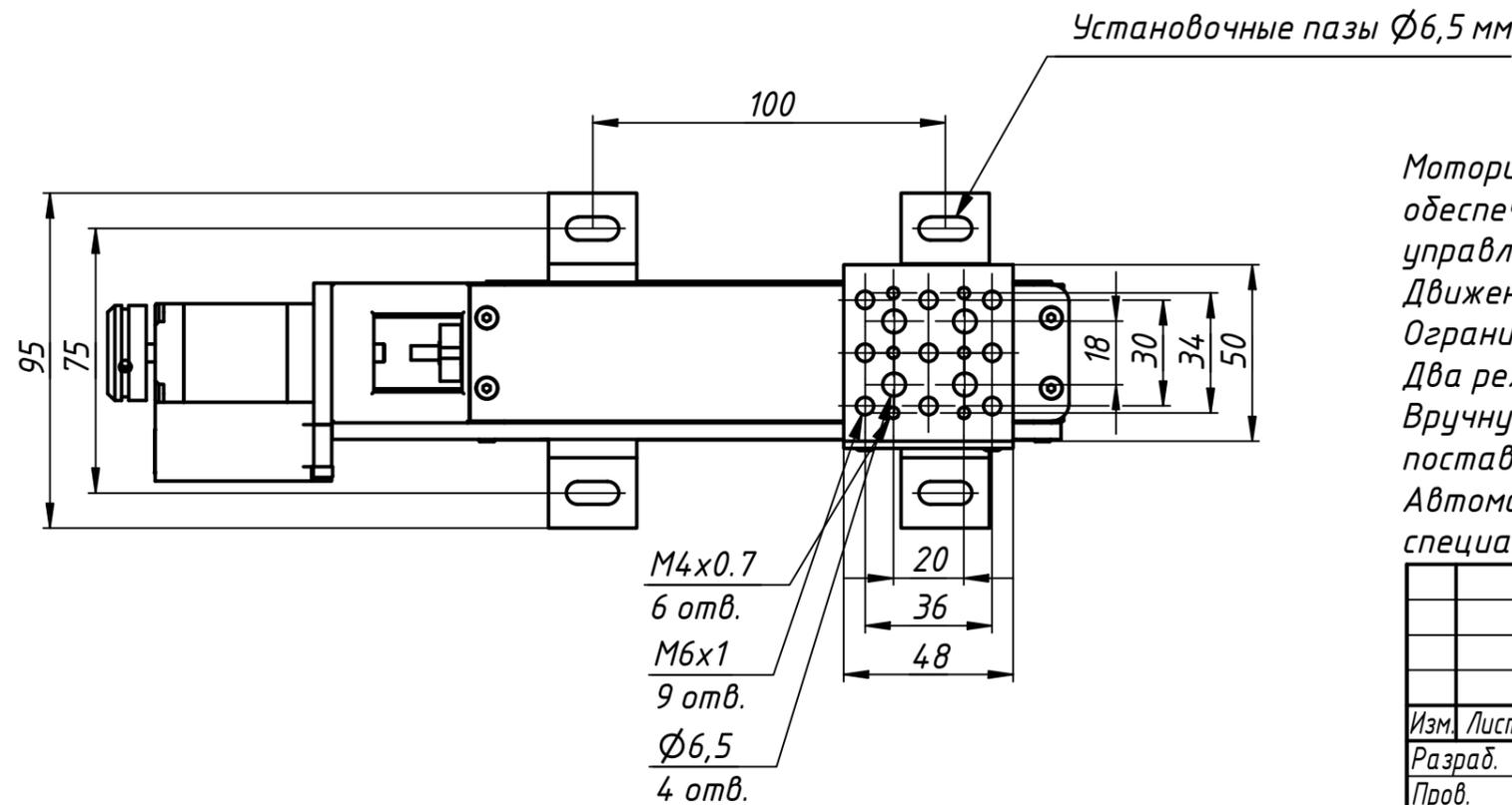
Моторизованные оптические трансляторы TS36-SM, TS86-SM и TS135-SM обеспечивают плавное перемещение и высокую точность позиционирования при управлении от компьютера.
