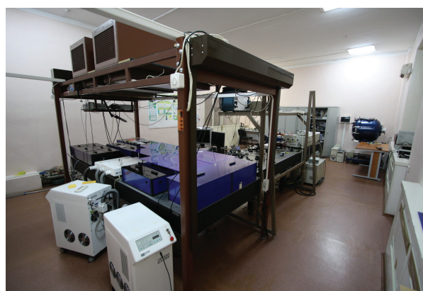
Тераваттная хром-форстеритовая лазерная система FREGAT-TW
