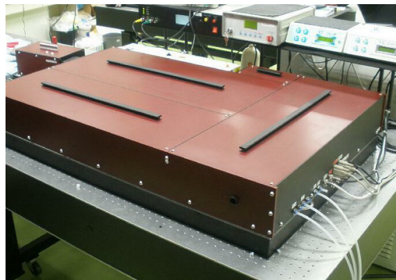
Фемтосекундный регенеративный хром-форстеритовый усилитель FREGAT-200K
