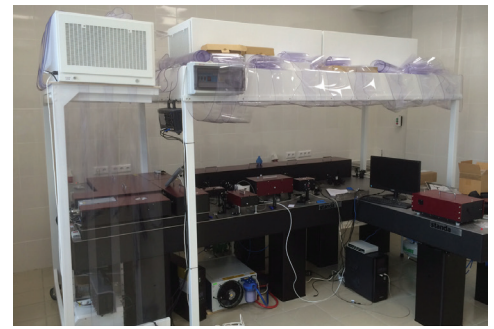
Лазерная установка на базе усилительной системы REUS-3m1k (3 мДж, 1 кГц, 35 фс) с капиллярным компрессором Compulse и приборами диагностики
